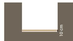
**3** Installer l'appareil au fond de la fouille et parfaitement de niveau. Le centrer par rapport à la fouille. Attention au sens de pose, respecter le sens de circulation des effluents. L'entrée et la sortie sont marquées respectivement d'un E ou d'un S ou une flèche indique le sens de l'écoulement.
